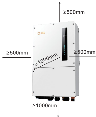
Bild 3.5 Avstånd vid montering av växelriktare
